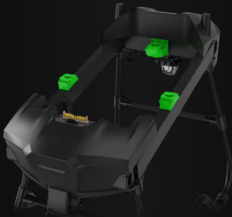
El sensor de peso le permite controlar el nivel de pesticida restante en tiempo real.
