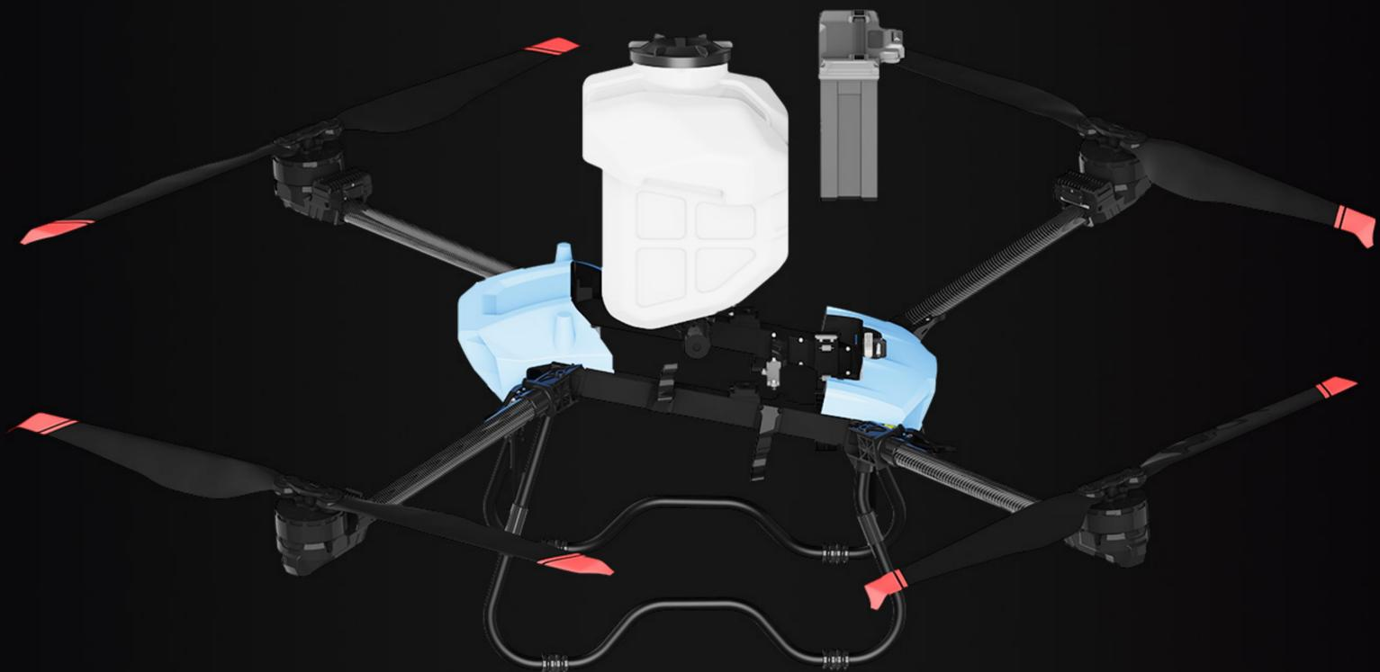
El depósito de pulverización enchufable e integrado se puede cambiar rápidamente por el depósito de pulverización
